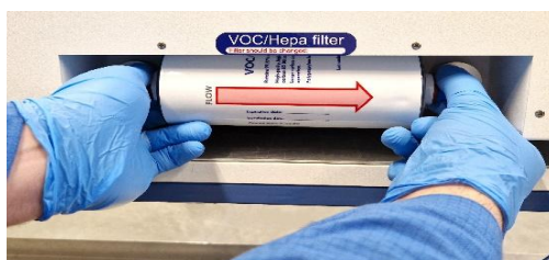
Figur 12.2 Fremgangsmåde for isætning og fjernelse af VOC/HEPA-filter
