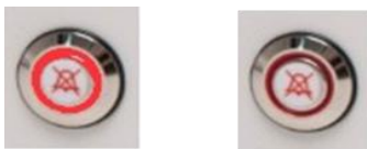
Figur 15.1 Alarmknappen, der viser alarmtilstanden
